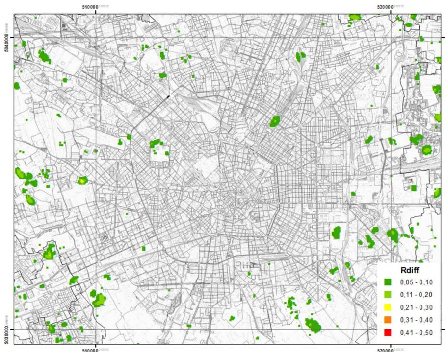
Figura 23 - Differenze superiori a 0.05 nelle matrici di trasformazione estratte da due Landsat notturne (2 Agosto 2015 e 26 Agosto 2018) utilizzabili per il downscaling delle immagini LST MODIS
