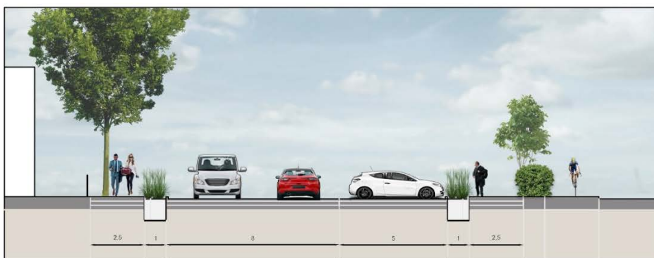
Figura 37. Stato di progetto – Alternativa 3.1. Planimetria e sezione di un tratto di Via Lombardia, Città di Parabiago (MI)
